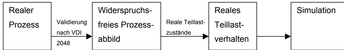
Abbildung 11: Vorgehensweise bei Berücksichtigung von Teillastzuständen und Simulation
